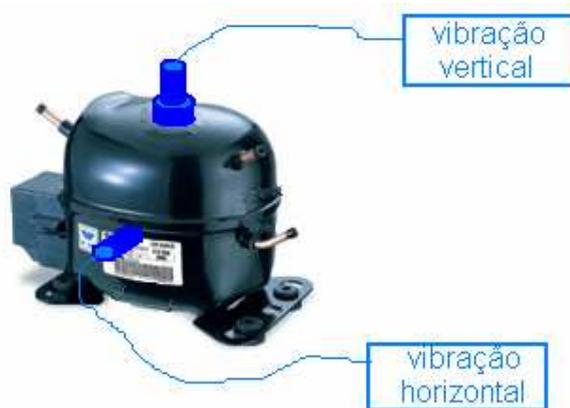
Figura 4.2 – Medição de vibração.
