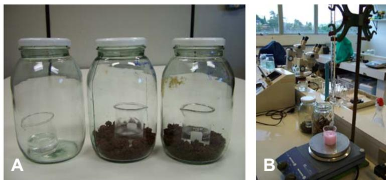
FIGURA 13. Frascos para análise de CO<sub>2</sub> (A) com armadilhas (béquer com solução de NaOH) para captura do gás carbônico – frasco extrema esquerda: prova em branco. Titulação da solução de NaOH com HCl de mesma normalidade (B) para cálculo da quantidade de CO<sub>2</sub> liberado.
