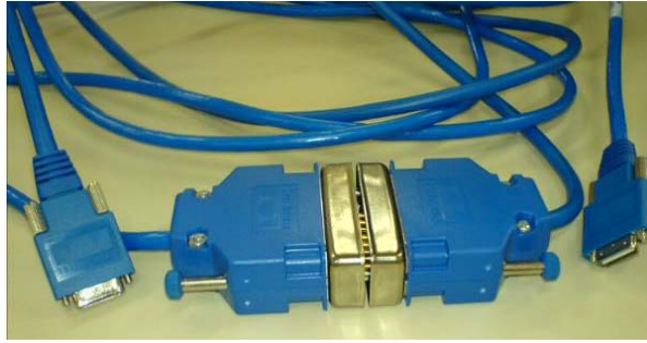
Figura 5-9 -Conexão back-to-back com cabos V-35
