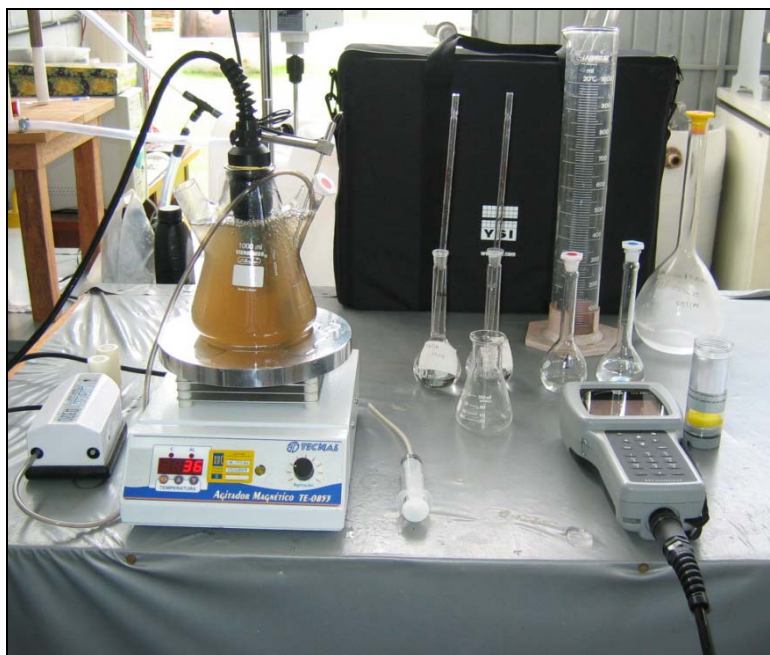
Figura 4.6-Foto da aparelhagem para a determinação do QO_2 no laboratório
