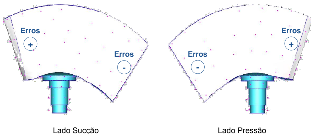
Figura 47 – Comportamento dos erros nos lados da pá Kaplan.
