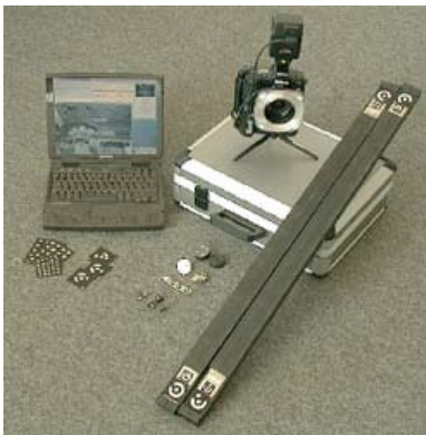
Figura 20 – Sistema fotogramétrico TRITOP da GOM [36] .
