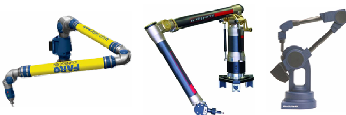
Figura 7 – Diversos braços articulados de medição [24],[25],[26] .
