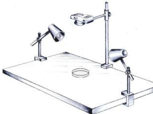
Figura 3.7: Esquema do sistema utilizado para realizar as fotografias com câmera digital
