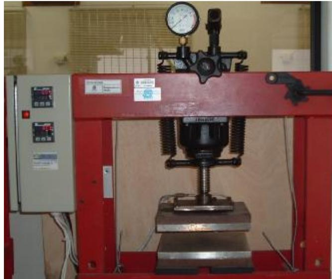
Figura 3.6: Termoprensa utilizada para elaboração dos filmes
