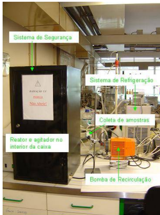
Figura 13: Piloto - sistemas de segurança, circulação e refrigeração
