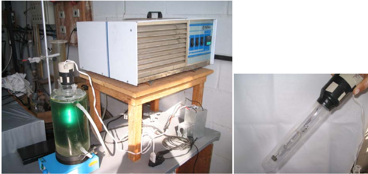
Figura 50: Sistema piloto utilizado nos experimentos e detalhe do tubo de quartzo com a lâmpada
