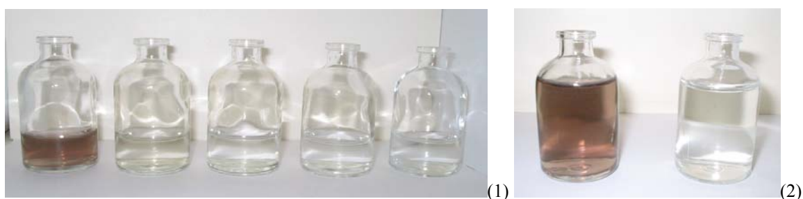
Figura 67: Aspecto visual dos ensaios: (1) - 250 \text{mgH}_2\text{O}_2/\text{L} (efluente, 15, 30, 45 e 60 minutos de irradiação UV); (2) - 500 \text{mgH}_2\text{O}_2/\text{L} (efluente e 60 minutos de irradiação UV)
