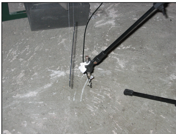
Figura 3.5 Detalhe do posicionamento do microfone para evitar efeitos do movimento de corpo rígido da placa nas medições de pressão sonora.
