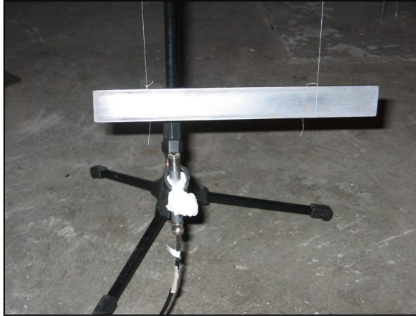
Figura 3.4 Fios de linha suspendendo a chapa nas linhas nodais de um dos modos de vibração.
