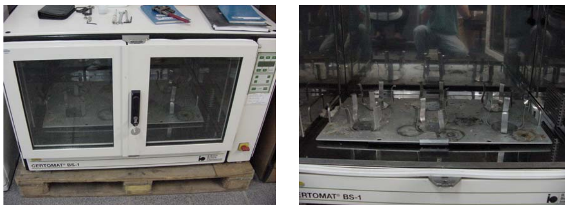
Figura 3.1 - Shaker Certomat BS-1 utilizado nas culturas de R. eutropha em frascos agitados.
