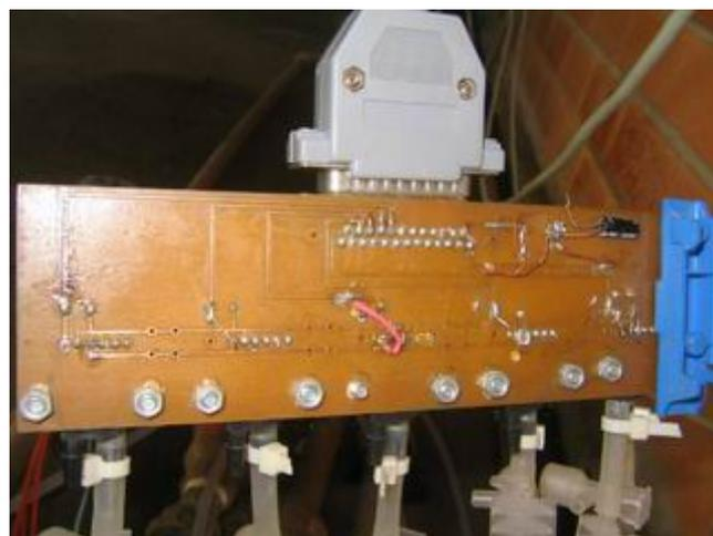
**Figura 40. Borneira dos sensores de pressão lado 2**
