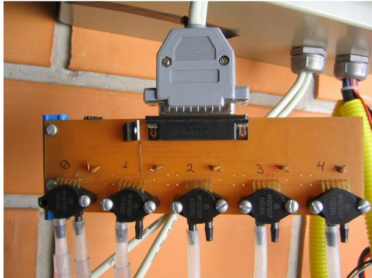
**Figura 39. Borneira dos sensores de pressão lado 1**
