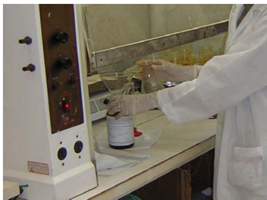
FIGURA 11 - Ataque ácido (ácido clorídrico e nítrico na proporção 3:1)
