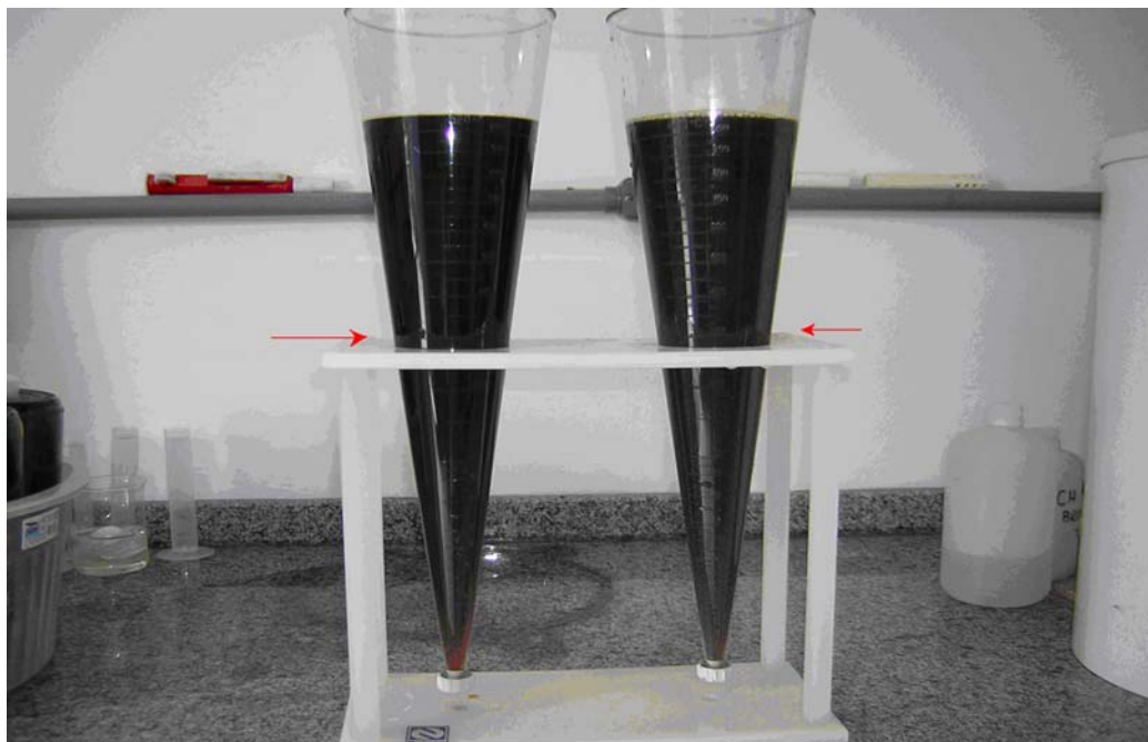
FIGURA 33 - Cones Imhof no ensaio de determinação do volume de lodo
