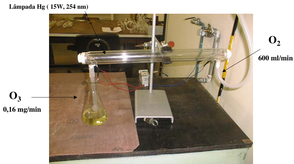
Figura 22. Sistema de produção de ozônio construído no laboratório conforme MATUSIEWICZ e MROCZKOWSKA 79 e CAPELO-MARTÍNEZ et al. 92 .
