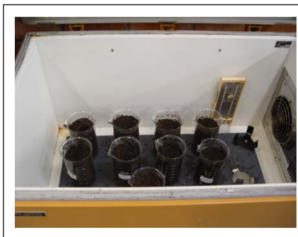
Figura 3.10 – Esquema do acondicionamento dos filmes nos ensaios de biodegradação, a partir das amostras de 50/50, 70/30 e 90/10 de LDPE/amido de mandioca, obtidos por extrusão e termoprensagem, com dimensões de 5,0 cm 2 .
