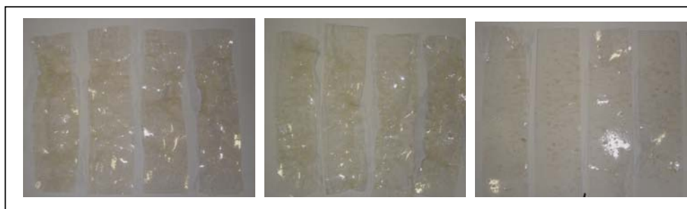
Figura 4.1 – Figuras das blendas 50/50, 60/40 e 70/30, respectivamente, de LDPE/amido de mandioca/glicerol, acondicionados em umidade relativa de 75%, antes dos ensaios de tensão-deformação.
