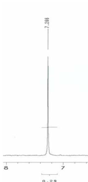
Figura 20: Espectro de RMN de ^1\text{H} mostrando o sinal em 7,27 correspondente aos hidrogênios aromáticos do 2,4,6-trinitrofenol.
