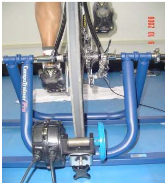
Figura 2: Ciclosimulador CompuTrainer Profissional modelo 8001 ( RaceMateInc ® )
