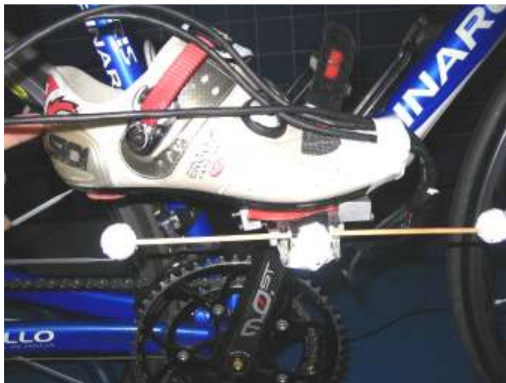
Figura 5: Estrutura montada no pedal para a identificação dos ângulos do pedal através da cinemetria.
