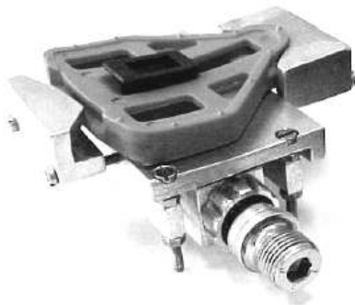
Figura 3: Pedal instrumentado (direito), cedido especialmente pelo LAPEX-ESEF-UFRGS.
