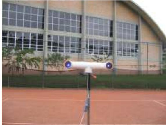
Figura 7 – Sinalizadores luminosos (*Led*), utilizados para dar o início e a direção a ser tomada pelo indivíduo no teste de agilidade de Monte.
