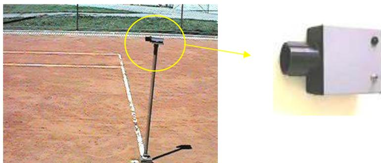
Figura 6 – Sensor de passagem infravermelho com seu respectivo suporte.
