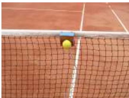
Figura 5 – Sensor de toque do tipo *push-button*.
