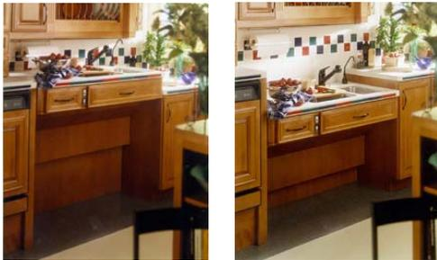
**Figura 70: Bancada com ajuste de altura automático.**
