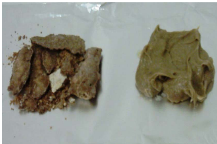
Figura 16 Foto do saponificado obtido da RBOS (esquerda) e da matéria-prima (RBOS, à direita).
