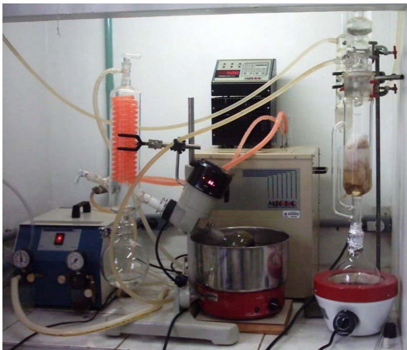
Figura 9 Aparato utilizado para extração e evaporação do solvente na etapa de extração dos insaponificáveis presentes no segundo saponificado da RBOS.
