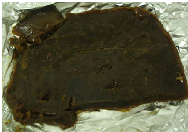
Figura 18 Foto da fração insaponificável obtida pós-tratamento com solução metanol-acetato de etila (1:1).
