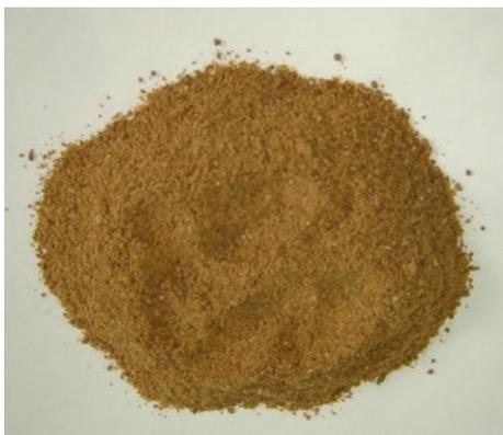
*Figura 4.1 - Bagaço de maçã seco e triturado empregado nos experimentos de extração.*
