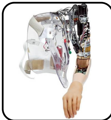
Ilustração 32 – Braço biônico confeccionado sob medida para o usuário
