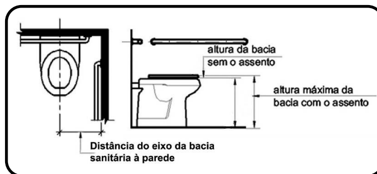
Ilustração 113 - Distância do eixo da bacia sanitária à parede
