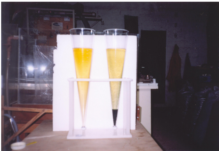
Figura 6.20: Cones de Imhoff com efluentes do pós-tratamento eletrolítico com eletrodos de alumínio (à esquerda) e com ferro (à direita).
