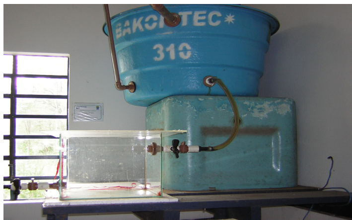
Figura 5.9: Reservatório superior acoplado ao reator eletrolítico desmontado.
