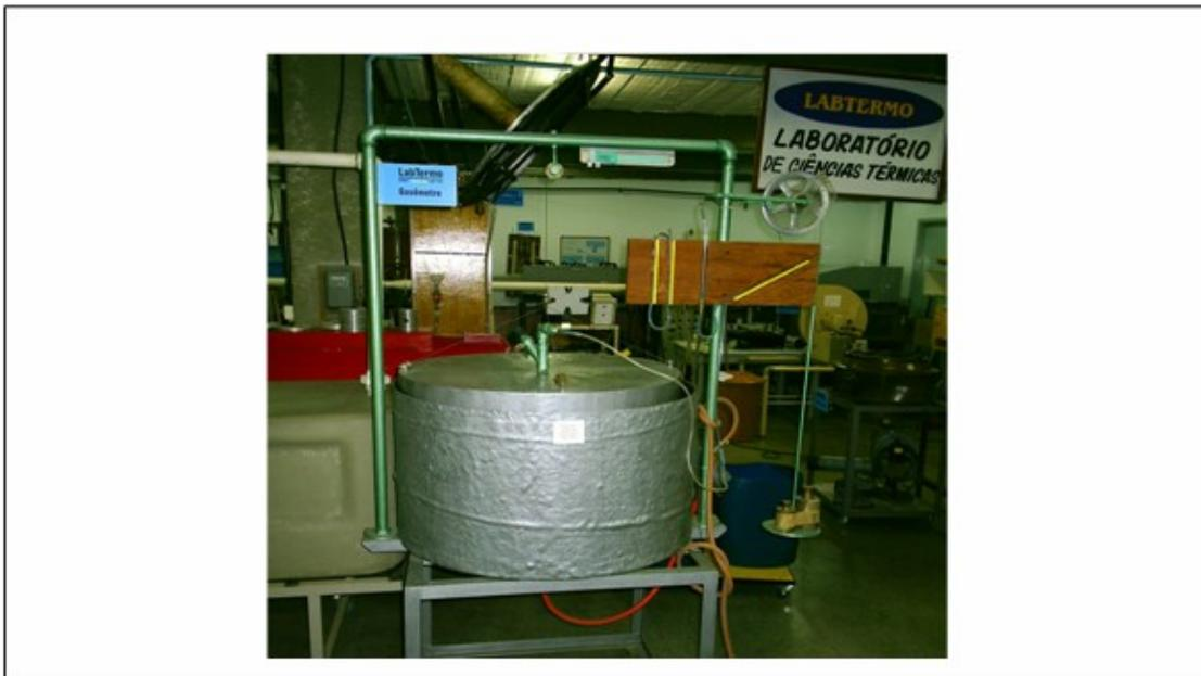
FIGURA 7 - Foto do gasômetro utilizado
