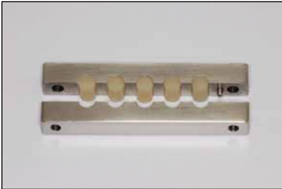
Figura 10 - Abertura da matriz para remoção dos espécimes.
