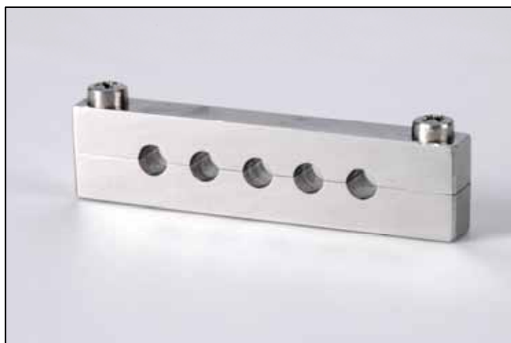
Figura 7 - Matriz bipartida utilizada na confecção dos espécimes para teste de compressão.
