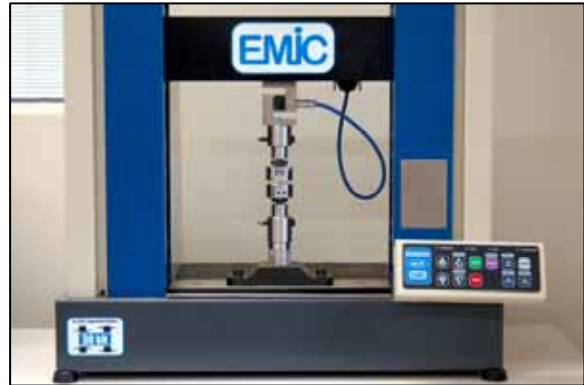
Figura 11 - Espécime posicionado na máquina de testes universais para aplicação de carga de compressão.
