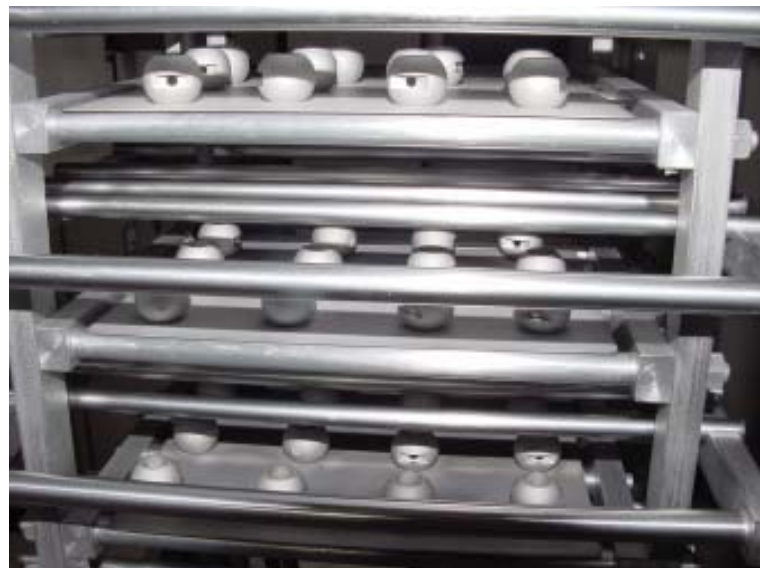
Figura 63. Peças processadas em aço inoxidável no reator PADS.
