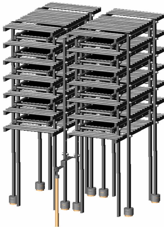
Figura 14. Eletrodos para a descarga de plasma do reator PADS.
