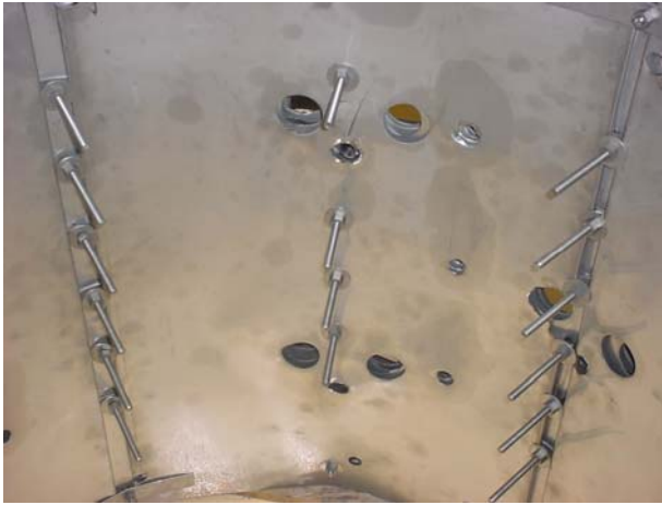
Figura 36. Mufla térmica do reator PADS.
