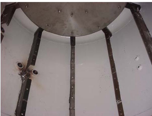
Figura 34. Parte interna da câmara superior – estrutura de fixação da mufla térmica.
