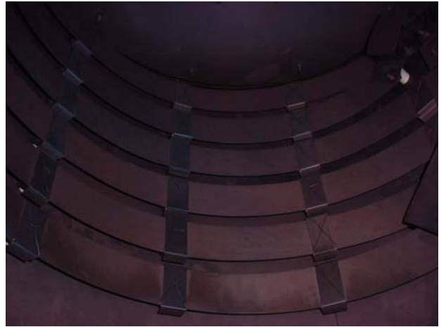
Figura 39. Mufla térmica – resistores elétricos e sua fixação.
