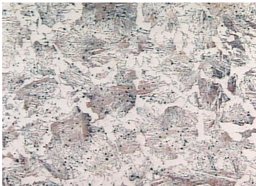
Figura 50. Micrografia do aço Fe 2 Ni 0,6 C produzido no reator PADS.
