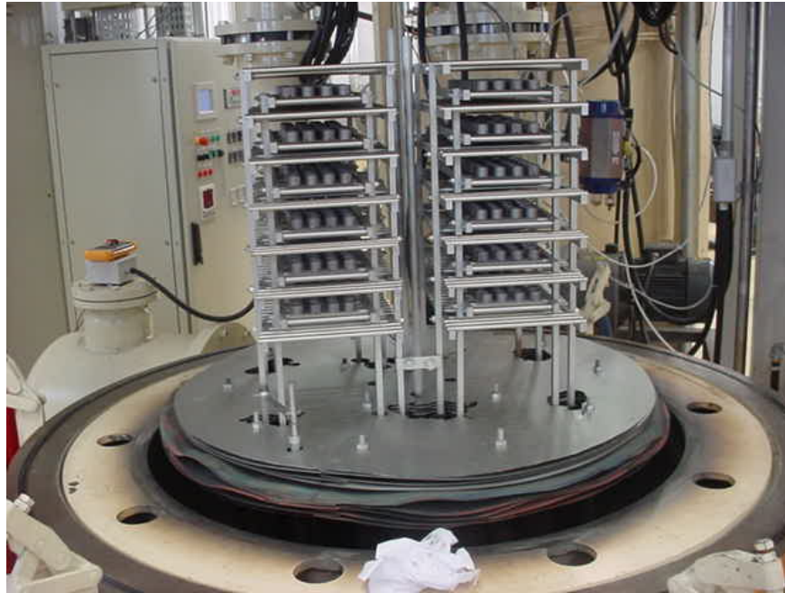
Figura 51. Peças processadas em aço ao carbono no reator PADS.
