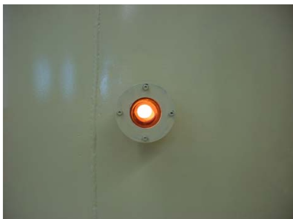
Figura 45. Reator PADS com descarga de plasma na faixa de temperatura de 600 °C.
