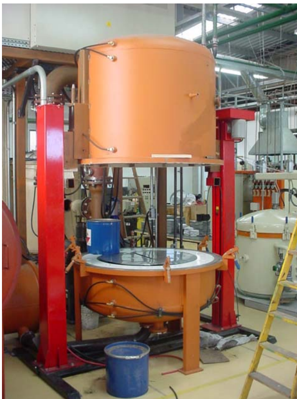
Figura 32. Montagem das câmaras do reator com o eleva-car.
