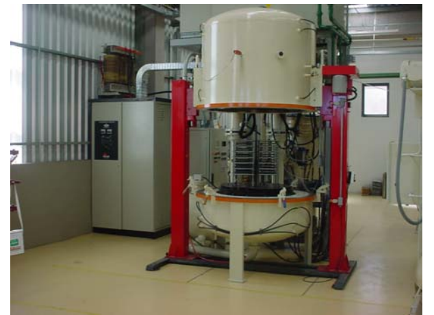
Figura 41. Reator PADS aberto, com a fonte de plasma ao lado (esquerdo).
