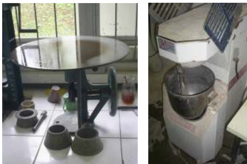
Figura 24 – Mesa de espalhamento e equipamento de mistura
