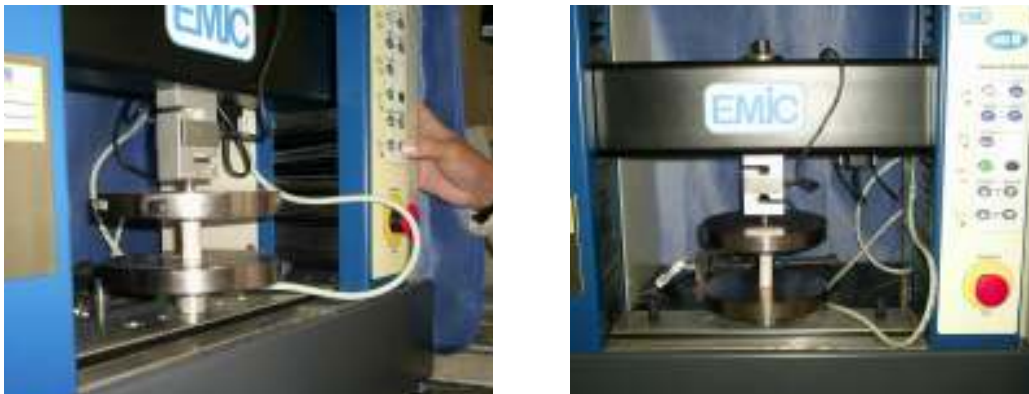
Figura 17 – Equipamentos utilizados para determinação da resistência à compressão das pastas
