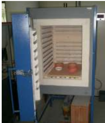
Figura 16 – Mufla utilizada para a calcinação dos finos de RCD
