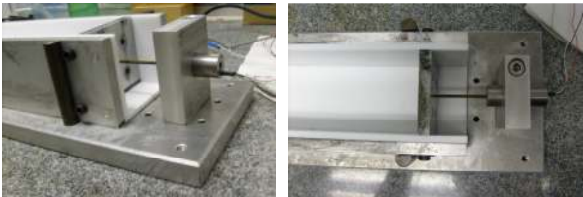
Figura 20 – Equipamento utilizado no ensaio de retração plástica em concretos
