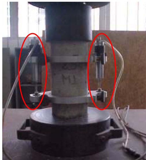
Figura 23 – Medidores de deformação longitudinal dos concretos
