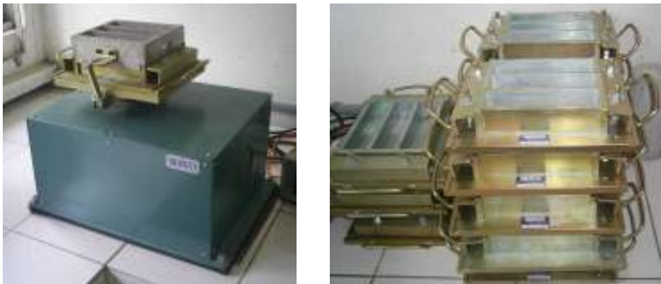
Figura 25 – Equipamento de compactação e moldes dos corpos-de-prova prismáticos
