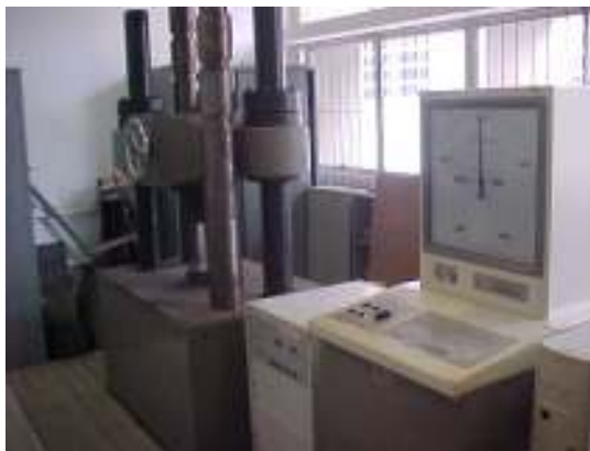
Figura 21 – Equipamento utilizado para resistência à compressão dos concretos
