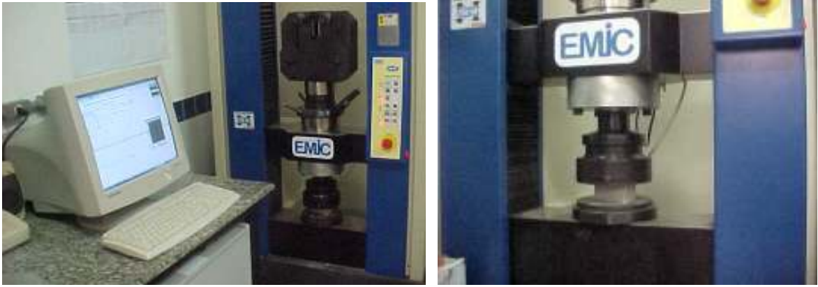
Figura 29 – Equipamentos utilizados para o ensaio de resistência à tração na flexão e resistência à compressão
