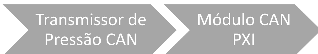
Figura 5.5- Cadeia de medição de pressão utilizando transmissor CAN
