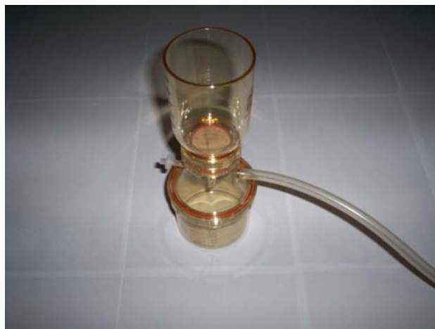
Figura 12. Ilustração do sistema de Filtração da água de chuva de Florianópolis, utilizando o micro-filtro Millipore 0,45 \mu\text{m} .
