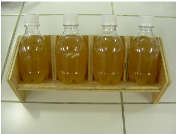
Figura 3.2. Garrafas de PET contendo suco de abacaxi, em suporte inclinado a 45°.
