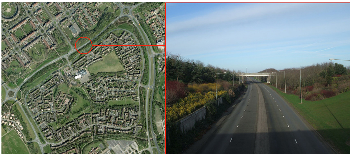
Figura 43: Um dos bairros autônomos de Milton Keynes e o destaque a uma das componentes do pesado sistema viário como a Marlborough Street . A via expressa é associada a muros, taludes e massa vegetal para garantir o isolamento e a introversão dos bairros. (FONTE: Imagem de satélite: Google Earth . Foto: JSmith9114, disponível em: < http://www.flickr.com/photos/jsmith9114/451073590/ >. Acessado em: fevereiro de 2008).
