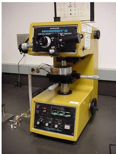
(a) Testador de microdureza
