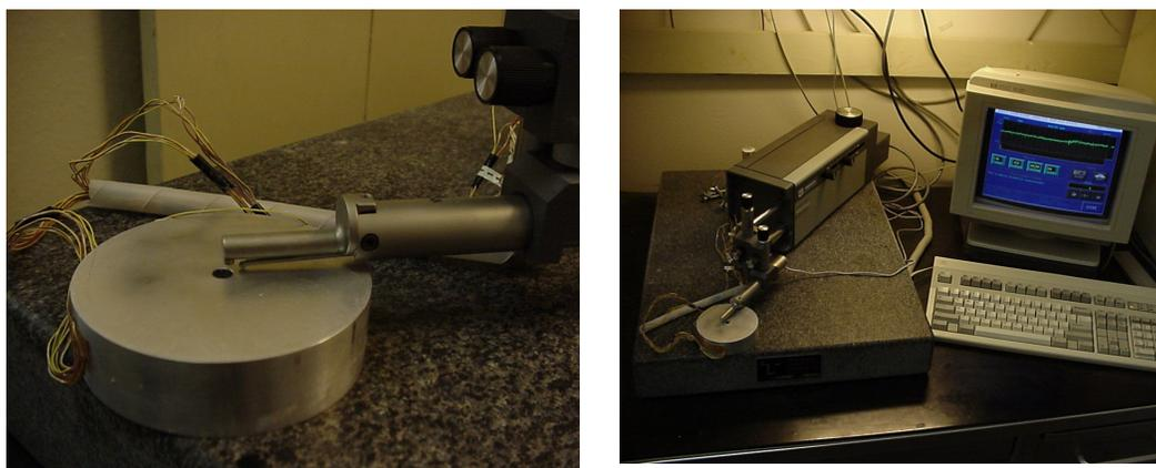
(a) Placa metálica e rugosímetro
