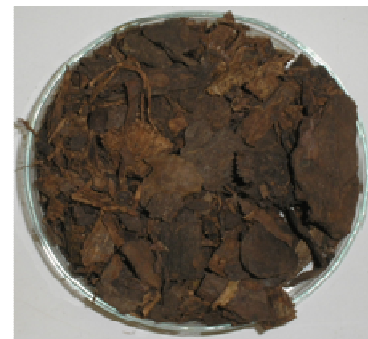
Figura 5.1 Material constituído de casca da Acácia utilizado como suporte de um biofiltro para tratamento de vapores de gasolina
