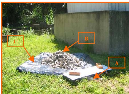
**Figura 7 - Experimento montado com o resíduo gerado nos cultivos (conchas mais sedimento marinho agregado). A) Recipiente para recolhimento do líquido percolado. B) Pilha de resíduos. C) Superfície impermeabilizante.**
