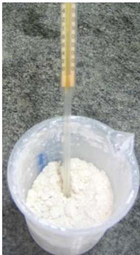
**Figura 45. Processo de hidratação do óxido de cálcio obtido a partir das conchas.**
