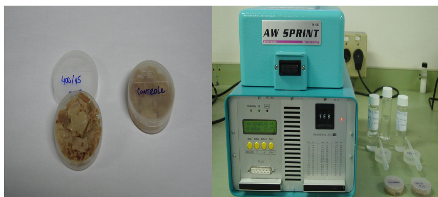
Figura 3.4 - Amostra controle e pressurizada no recipiente (a); Equipamento Higrômetro Eletrônico Novasina Aw-Center com amostra dentro da célula.
