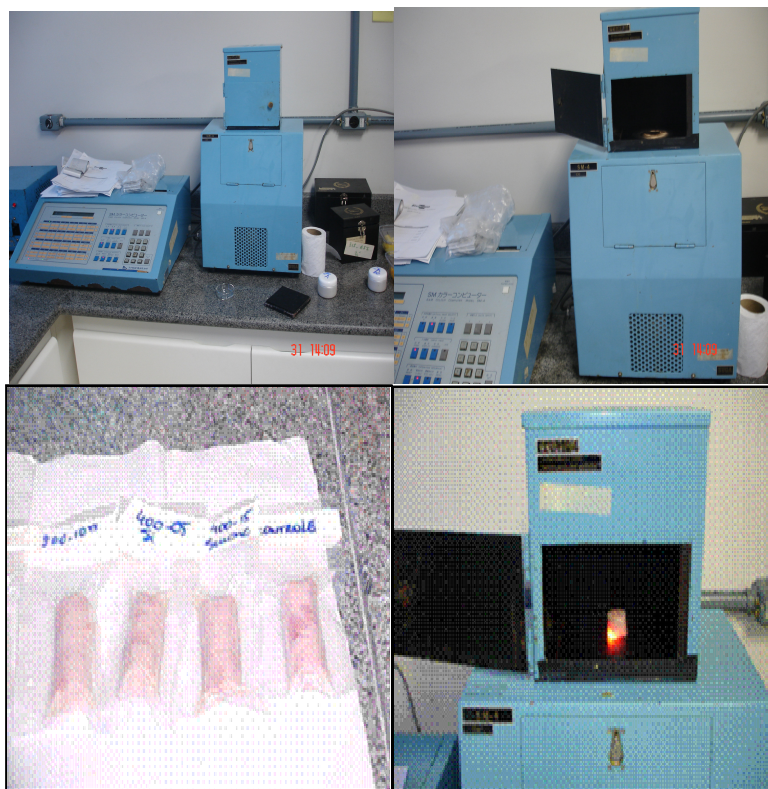
Figura 3.5 - Equipamento de cor S & M Colour Computer modelo SM – 4 – CH utilizado para as análises de L* e a*.
