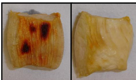
Figura 3.8 - Douramento na superfície das amostras de frango após o cozimento, para os aquecedores com pico de emissão em 3,3 e 1,5  $\mu\text{m}$ , respectivamente.
