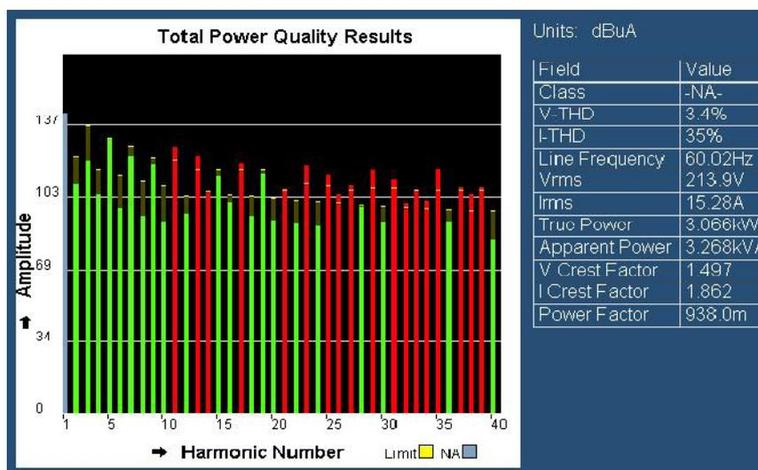
**Fig. 5.49 – Análise da Potência Processada pelo retificador Unidirecional.**
