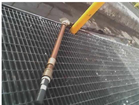
Imagem 3 - Sonda de OD durante calibração
