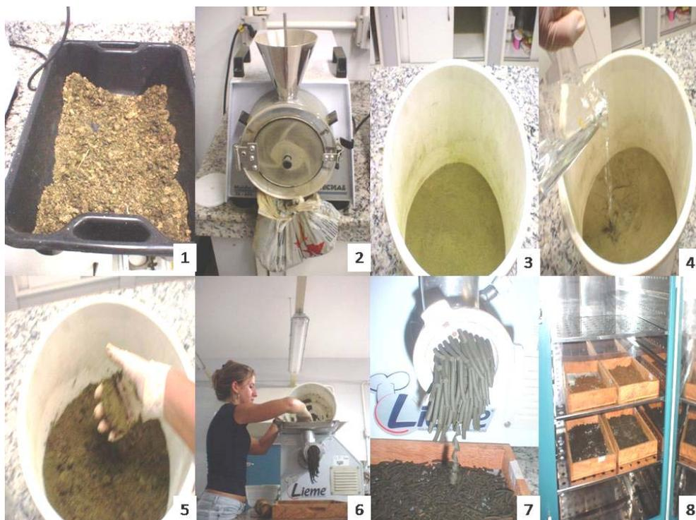
Figura 15. Fases do processo de peletização das lemnas (1 – Lemnas secas; 2- Processo de moagem; 3- Lemna moída; 4 - Adição de água; 5- Processo de aglutinação; 6 – Peletização; 7 – Produção dos pellets; 8 – Secagem dos pellets).
