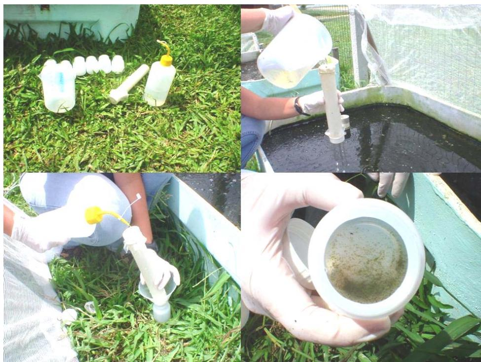
Figura 21. Procedimento de coleta e conservação zooplâncton (1 – Frascos de coleta; 2- Filtragem de 2 litros de efluente por tanque; 3 – Fixação do zooplâncton com Formol 4%)
