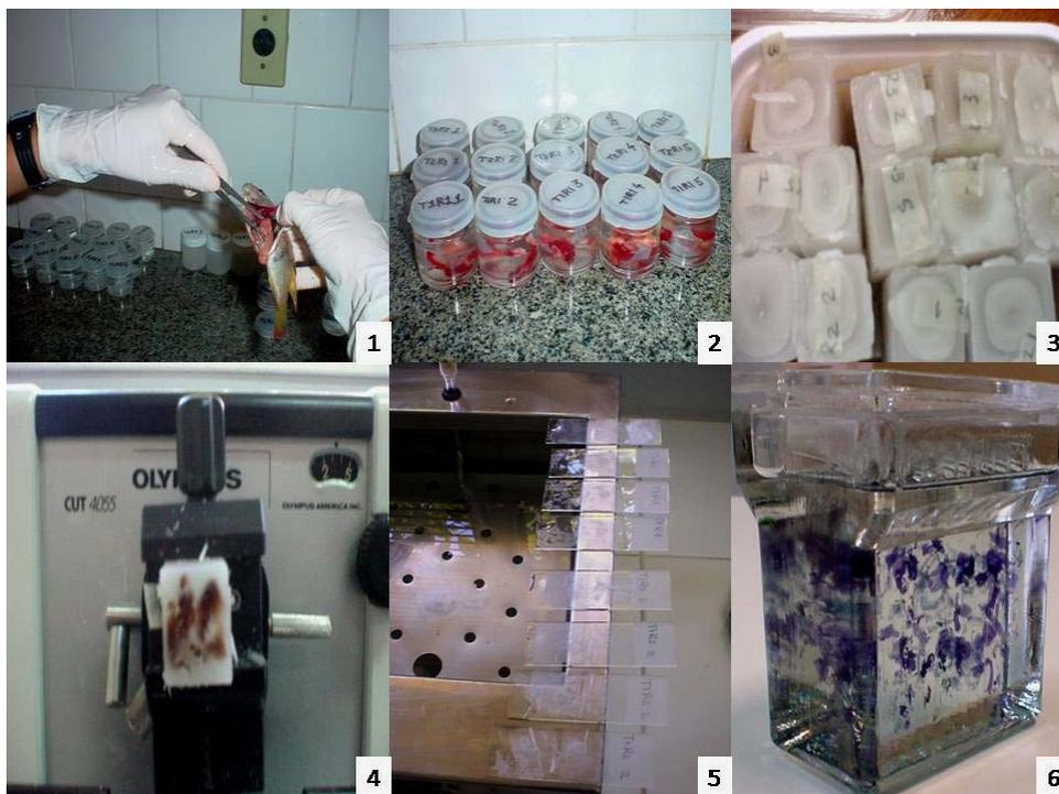
Figura 17. Etapas necessárias para a realização das análises histopatológicas (1- Coleta do fígado e das brânquias dos peixes; 2 – Fixação em solução de formol; 3 – Processo de Inclusão; 4 – Microtomia; 5 - Montagem da lâmina histológica; 6 – Processo de coloração
