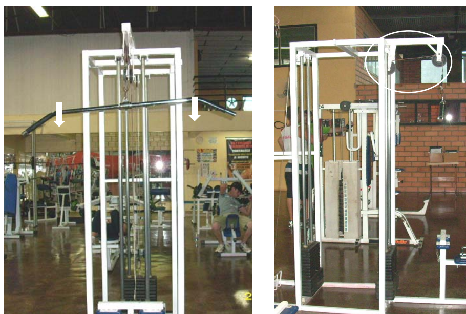
Figura 2 – Aparelho tradicional de musculação (AT) para o exercício “Puxada Alta” utilizado para a realização do estudo. Na primeira foto pode ser identificado a barra de tração e, na segunda foto, a vista sagital mostrando o sistema de polias do sistema.
