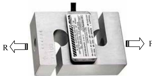
Figura 4 – Foto da célula de carga extensiométrica utilizada para mensurar a força exercida pelo sujeito durante os procedimentos de coleta de dados em cada um dos aparelhos de musculação selecionados para o experimento. As setas indicam a direção da força de tração e da resistência.
