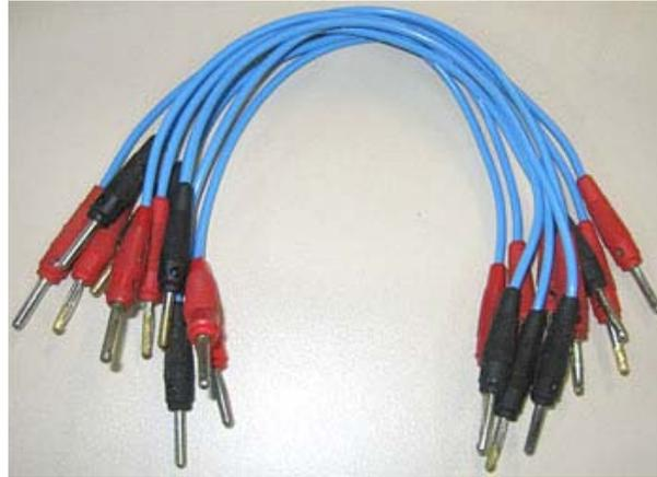
**Figura 5: Fios elétricos com pinos banana nas pontas.**
