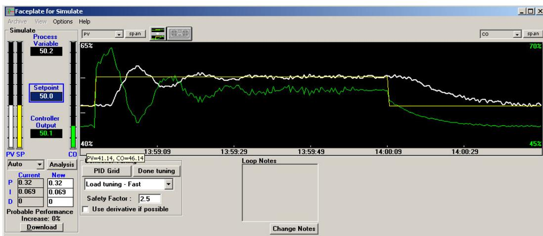
Figura 5.2 – Interface gráfica da ferramenta de sintonia automática *RS Tune* do fabricante Rockwell.
