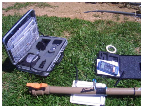
(a) Conexão entre o adaptador e a saída do biogás, na propriedade P1. (b) Medidor de gases (Dräger X-am 7000), tubulação e termo-anemômetro (TA45).
