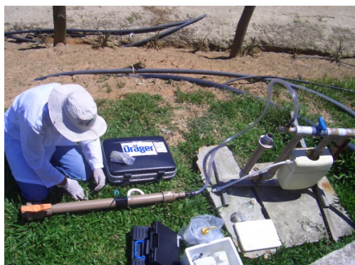
(a) Conexão entre o adaptador e a saída do biogás, na propriedade P1. (b) Medidor de gases (Dräger X-am 7000), tubulação e termo-anemômetro (TA45).
