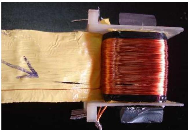
**Fig. 5-8 – Falha de isolamento entre bobinas.**
