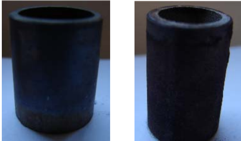
Figura 27 - Vista lateral dos filtros de aço inox 316L após o final do teste. Respectivamente filtro grande e pequeno, com a formação da camada óxida.
