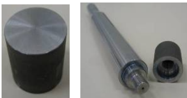
Figura 24 – Foto ilustrativa do corpo de prova de AISI 403 e eixo suporte confeccionado em aço SAE 1045.
