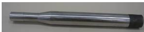
Figura 25 – Foto ilustrativa do corpo de prova de AISI 403 montado no eixo suporte rotativo para posterior encaixe no modelo (Pine Instruments Company – modelo ASR).
