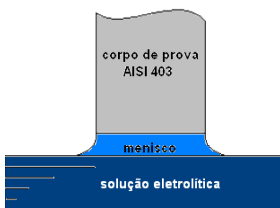
Figura 26 – Esquema da preparação do corpo de prova, utilizando o método do menisco. 43
