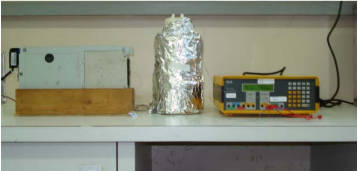
Figura 6: Sistema montado para a calibração dos termopares flexíveis tipo T. Ao centro, a garrafa de Dewar, e a direita o indutor de FEM no lugar do banho quente.
