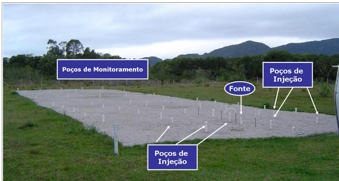
Figura 3.6 – Visualização geral da área do experimento de bioestimulação com injeção de nitrato na fazenda da Ressacada.
