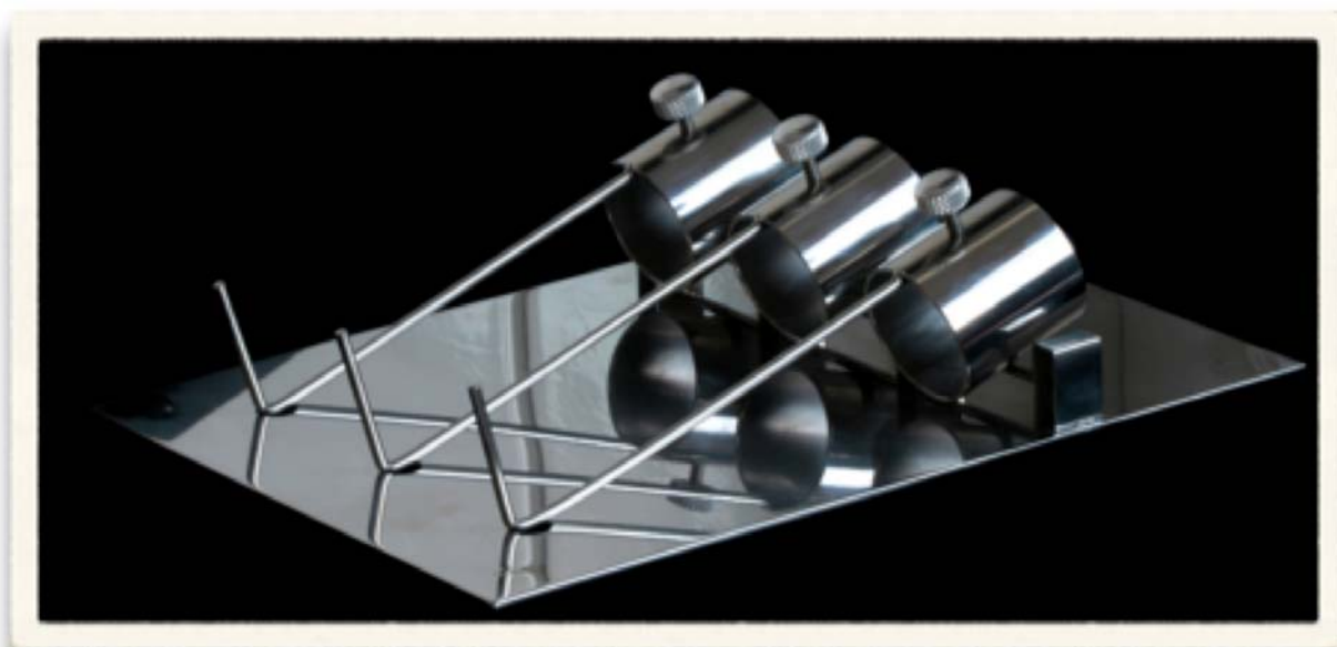
Figura 3 - Dispositivo de escovação simulada utilizado neste estudo.
