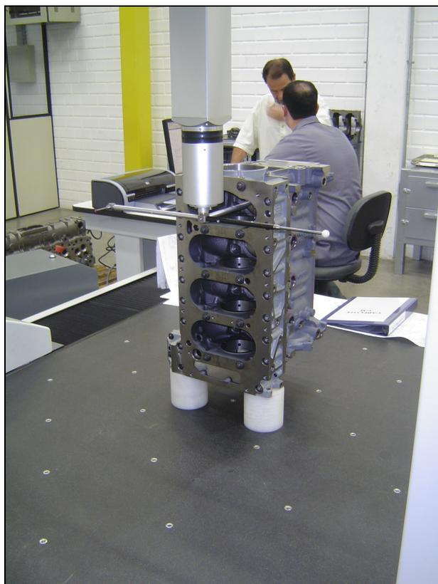
**Figura 37: Bloco de motor sendo medido na MMC**
