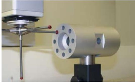
**Figura 10: Multi-Feature Check - peça universal de testes**
