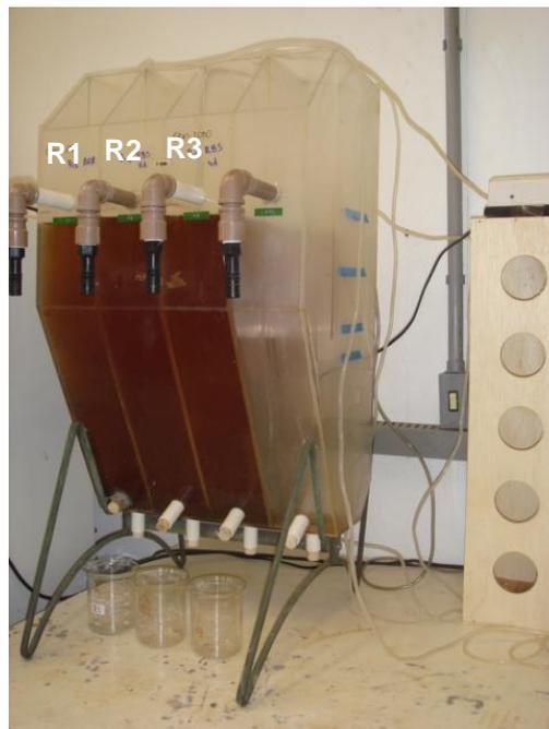
Figura 9: Reatores de bancada utilizados no tratamento do efluente.
