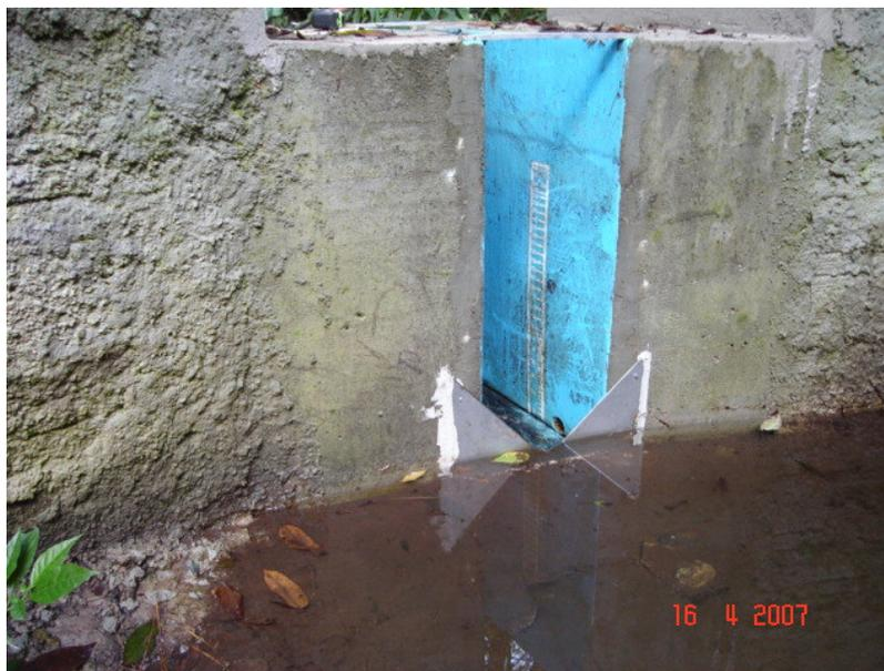
Figura 16 – Sistema vertedor - calha Parshall.
