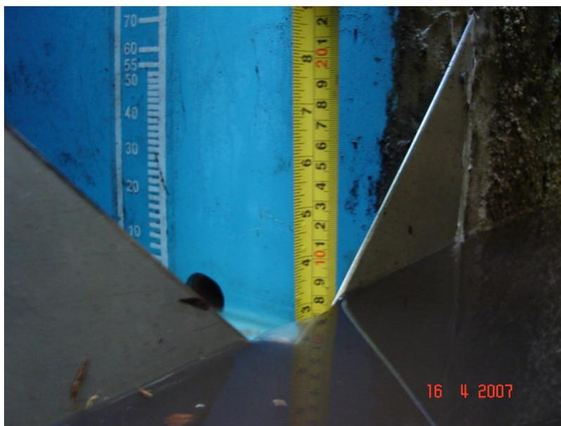
Figura 17 – Aferição do nível de água registrado no sensor de nível.
