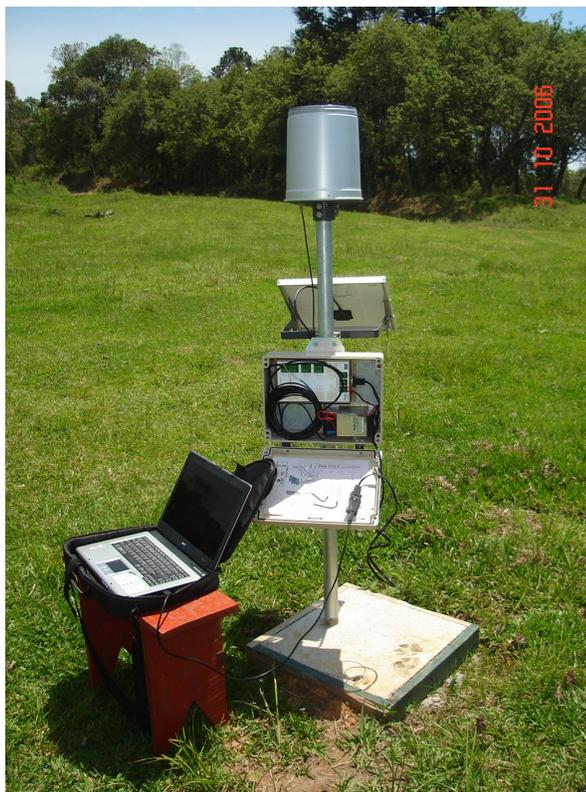
Figura 9 - Pluviógrafo e a coleta dos dados.
