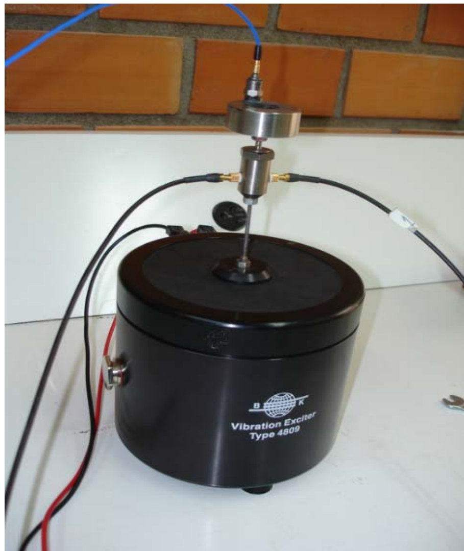
Figura 5.2 – Esquema para medição da transmissibilidade de um neutralizador
